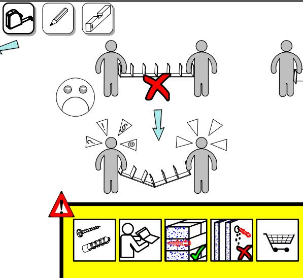
**CZ** Upozornění! Před montáží je nutné zkontrolovat stavěny. Přiložené univerzální hmoždinky jsou určeny pouze k použití pro pevný zdivo, jako beton/číhly. Hmoždinky do zdi se nesmí používat u dutinové cihly, zdiva jako písčitý stavební kámen, sádrokartonová deska nebo jiný měkký materiál. U této zdivu jsou nutně použít speciální hmoždinky! Jsou k dostání v speciálních prodejnách stavebním materiálem. Při nedodržení těchto pokynů výrobce/prodeje a dovoze neručí za způsobené škody.
