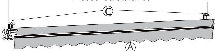
Markízu odporúčame umiestniť minimálne do výšky 2,3m od zeme. Pri vysunutí markízy, ktorá má sklon 21°, bude výška od zeme k najnižšiemu bodu markízy 2m.
