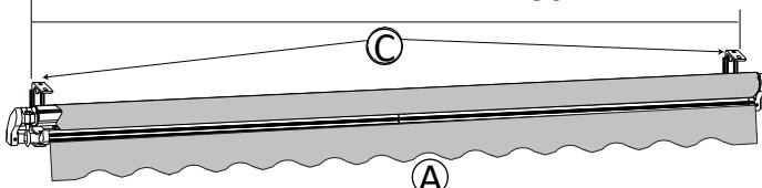
Markýzu doporučujeme umístit minimálně do výšky 2,3 m od země. Při vysunutí markýzy, která má sklon 21°, bude výška od země k nejnižšímu bodu markýzy 2 m.
